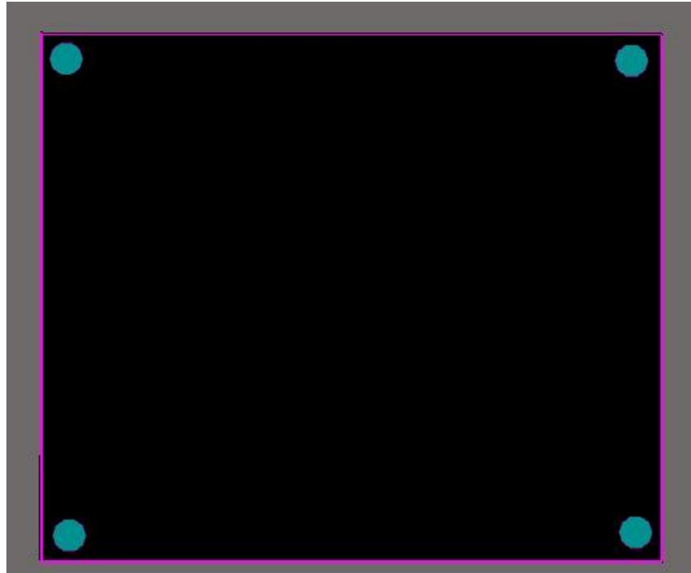
想象一下，PCB 就像是电子设备的“骨架”，支撑着各种电子元件，而板子的形状则决定了这个“骨架”的外形。如果板子形状设计不合理，如果板子形状设计不合理，没有写完如果板子形状设计不合理，就如同为电子元件搭建了一个不合适的“家”，不仅会导致元件布局困难，还可能影响整个电路的性能和设备的整体结构。比如，在设计一款小型手持设备的PCB时，若板子形状没有充分考虑设备的外壳尺寸和内部空间，可能会出现元件无法安装或者安装后散热不佳等问题。所以，学会建立合适的PCB文件并绘制精准的板子形状，是制作高质量PCB的重要基础。通过本任务的学习，你将掌握这一关键技能，为后续的PCB设计工作奠定坚实的基础。
